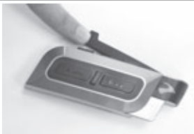
Выдвижная антенна для расширения диапазона связи
